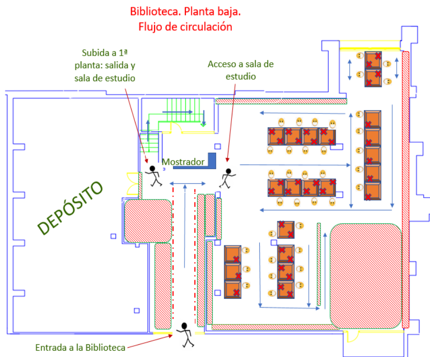
Figura 5.14. Flujo de circulación en la planta baja
